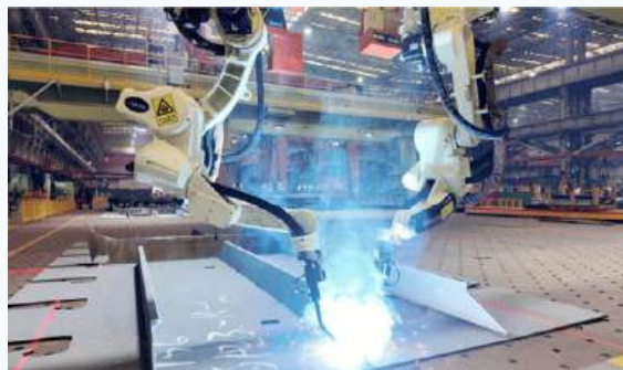
大型焊接机器人以毫米级精度安静作业
