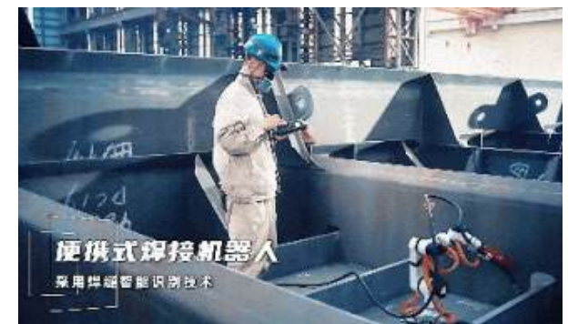
船用 AI 焊接机器人精准破解狭窄空间作业
