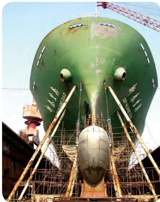
▲ 对“新秦皇岛”轮实施球鼻艏节能改造
